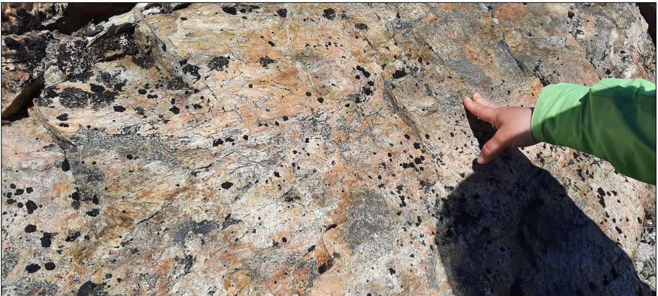
Figur 4: Foto af en sprække, som er brunlig i farven og bevokset med lav, hvilket viser på, at bevægelsen er sket for meget lang tid (>100 år) siden.
